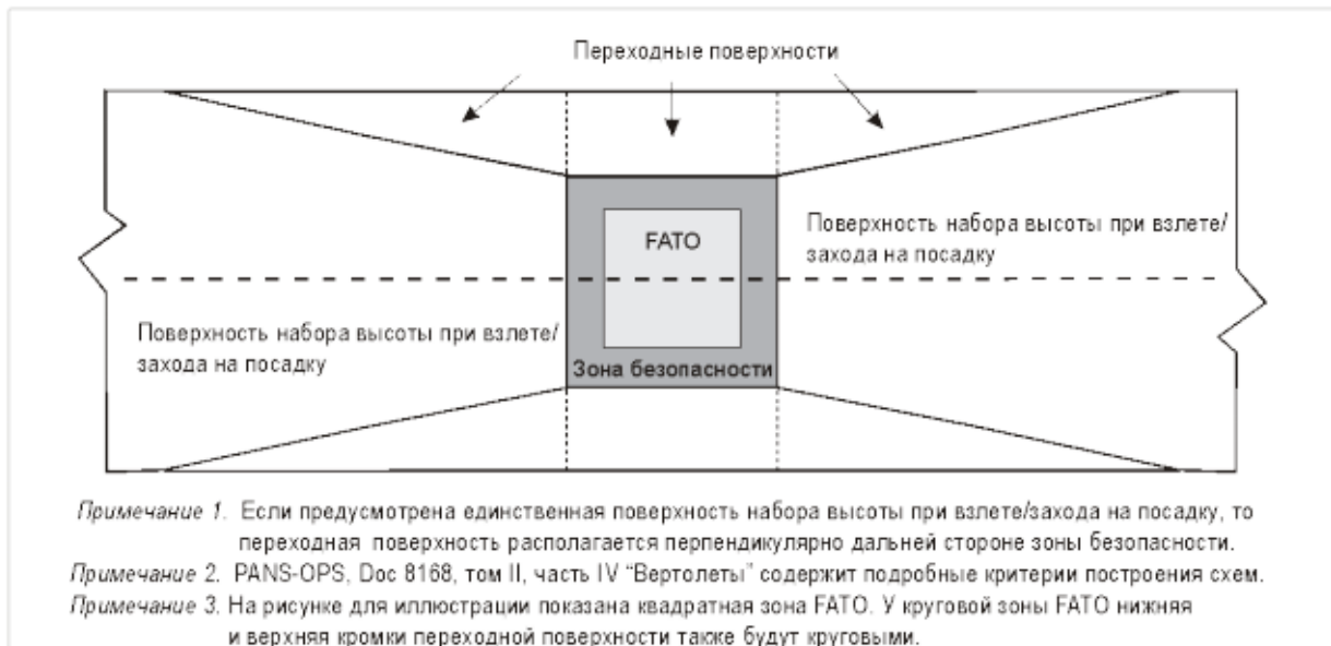
Рис. 4-3. Переходные поверхности для зоны FATO при применении процедуры захода на посадку до PinS с использованием VSS
