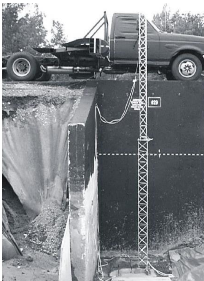
Рис. 5-1. Пример общей схемы испытания опор огней приближения с использованием ударного механизма, установленного на транспортном средстве.
