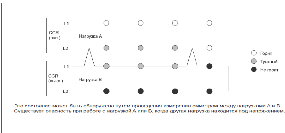
Рис. 16-7. Два коротких замыкания между нагрузками
