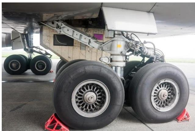
Рисунок №5. Шасси самолёта.
