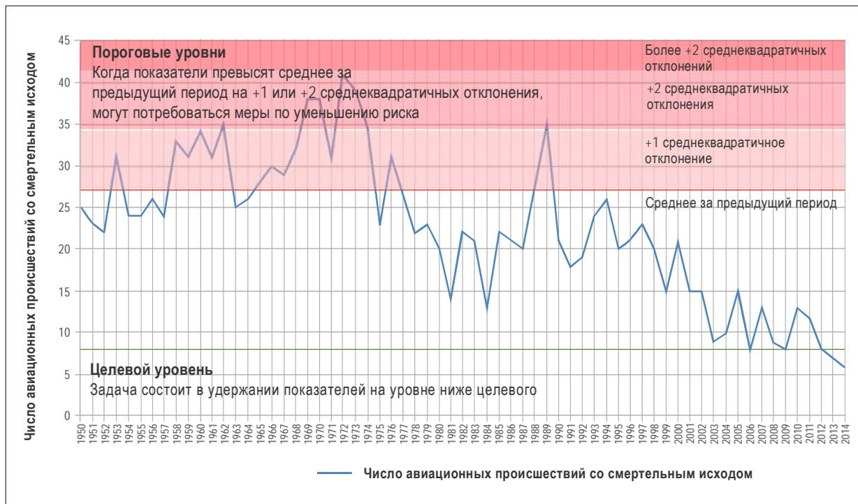
**Рис. 4-5. Пример наглядного представления (пороговых) значений триггеров в области безопасности полетов**
